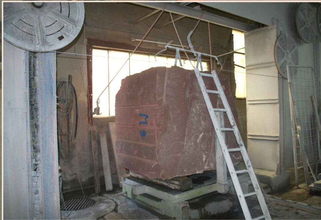
Rohblock bei der Bearbeitung mit der Seilsäge.
